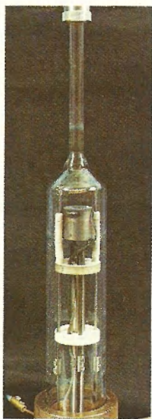
АЛМАЗНЫЕ КРИСТАЛЛЫ (справа) толщиной 10 мкм образуют тонкие «пленки», выращиваемые в лабораторных условиях. Одна из технологий получения таких пленок (слева) основана на разогревании газовой смеси метана и водорода раскаленной вольфрамовой нитью; возбужденные атомы углерода осаждаются на никелевую подложку. Фотографии предоставлены Научной лабораторией военно-морского флота.
